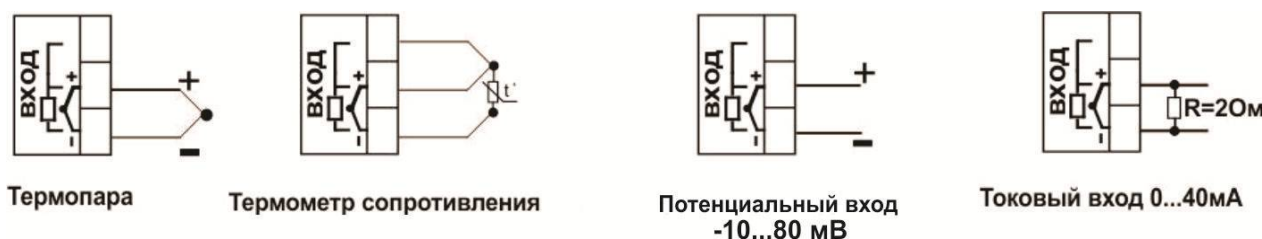
Рисунок 4 Схемы подключения датчиков.
